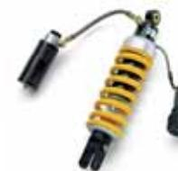
Per supportare carichi maggiori e mantenere una guida più sportiva; il "kit" prevede un ammortizzatore regolabile in estensione, compressione e precarico molla. Questa serie di regolazioni permette di determinare l'assetto e le prestazioni ciclistiche della moto, a seconda del peso trasportato e del terreno che si affronta. Acquistabile singolarmente (anche senza il kit molle forcella).
